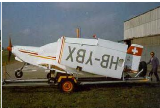
Mise en remorque en 15 minutes d'un BX-2 Suisse (Photo site concepteur).
