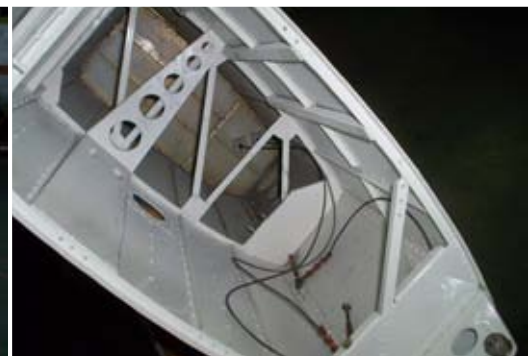
Structure de l'aile du RD-02 (photo Serge Gastan)
