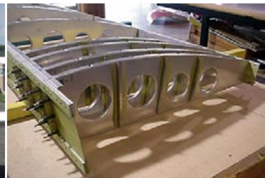
Structure de l'aile. (Photo Zenair)
