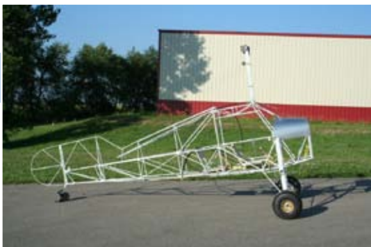
Structure du fuselage (photo concepteur)
