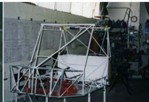
Fuselage en tubes du M85 de M. Kayser. (Photo www.campavia.com)
