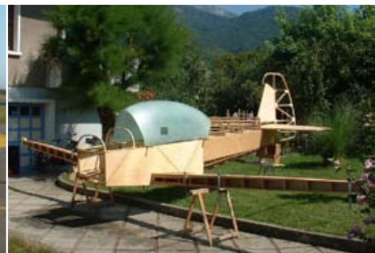
Mise en croix de la structure d'un CP751B Beryl #47 (Photo Alexandre, forum Avions Piel)
