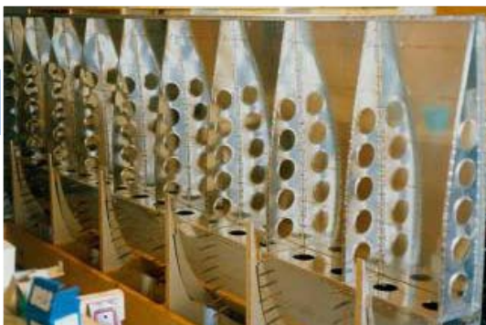
Structure de l'aile de l'Acrolite 2M (photo concepteur)
