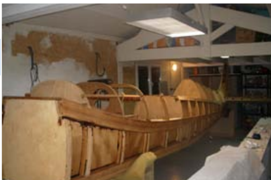
Fuselage bois du MJ-100 en cours de construction par Claude Martin près de Bordeaux (Photo constructeur)
