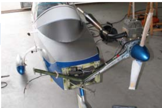
Vue Des pylônes de support moteurs. (photo PC)
