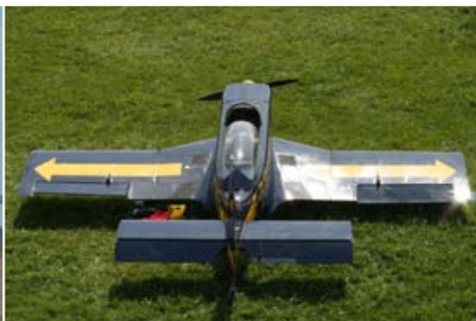
Vue de la voilure rectangulaire avec ses apex de train rentrant caractéristiques du Sirocco.
