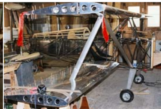
Mise en croix du prototype (Photo concepteur)
