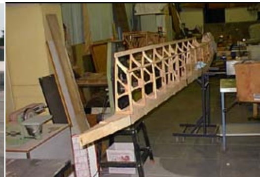
Structure de l'aile du P130UL (Photo concepteur)
