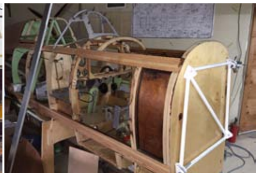
Fuselage du MJ-10 d'Alain Rougetet, en construction aux Mureaux (Photo constructeur)
