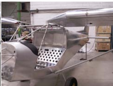
Vue de la cabine en tubes lors de l'assemblage. (Photo G1 Aviation)
