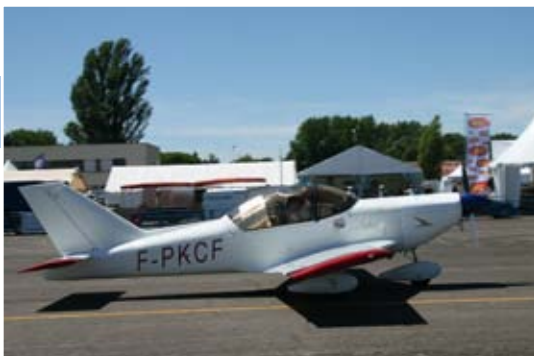
Saphir train tricycle fixe construit par Claude Klimczak en 1998. (Photo C. Ravel)
