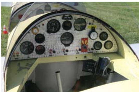
Druine Turbi construit par François Carzola en 1998. Tableaux de bord avant et arrière (Photo C. Ravel)
