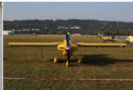
P70S, vue de l'aile médiane sans dièdre. (photo PC)
