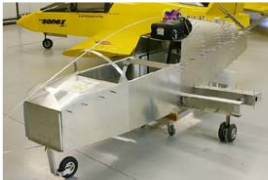
Structure du fuselage du SubSonex (photo concepteur)
