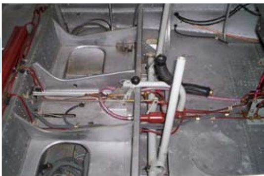
Détail des commandes de vol du RD-02 (photo Serge Gastan)
