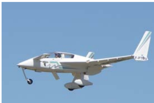
Train avant et aérofrein ventral sortis. (photo PC)
