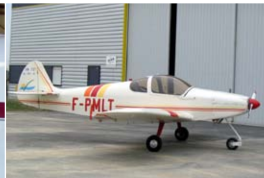
HN-701TM, version tricycle du HN700, construit par Max Mallet en 1999 (Photo constructeur)
