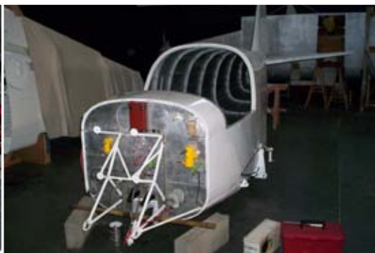
Cloison pare-feu et bâti moteur du RD-02 (photo Serge Gastan)
