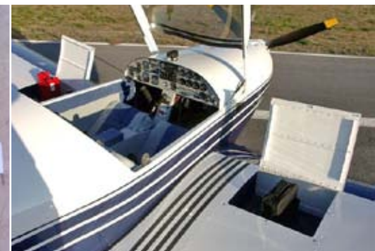
Coffres à bagages dans les ailes. (Photo site Barge Aviation).
