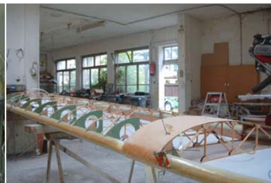
Structure de l'aile en bois, mousse et toile. (Photo site constructeur)
