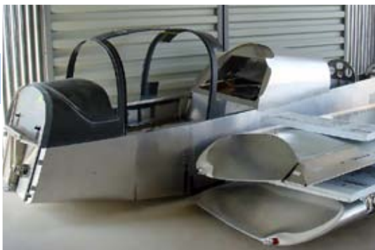
Éléments du fuselage et des ailes avant peinture (photo Zenair)
