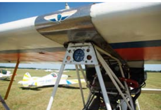
Vue du compte tour moteur, lisible depuis la place avant avec un rétroviseur. (Photo C. Roland)
