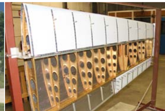
Structure de l'aile du Mustang II (photo concepteur)
