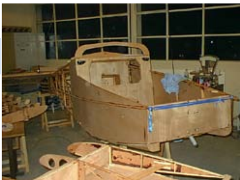
Structure du fuselage du P130 (Photo concepteur)
