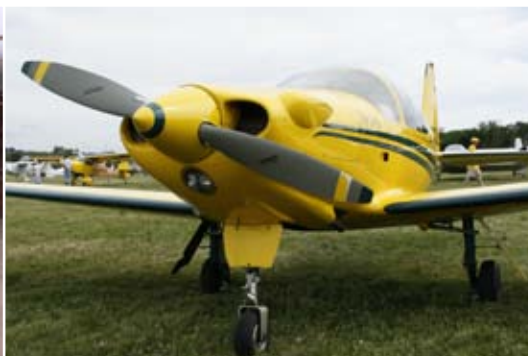
Vue des détails avant et du train rentrant du Falco construit par Jean-Marie Lafon en 2007.
