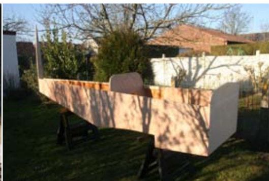
Fuselage avant mise en place du dôme arrière (photo Pierre Missol)
