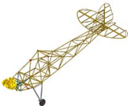
Vue de la structure en conception 3D (Photo concepteur)
