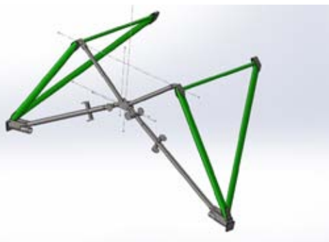
Vue 3D de la structure du train d'atterrissage principal (Photo concepteur)
