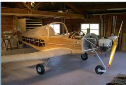
Structure du prototype en assemblage (Ph. JC Afflard)
