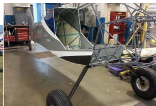
Rans S7 structure du fuselage (photo Rans)
