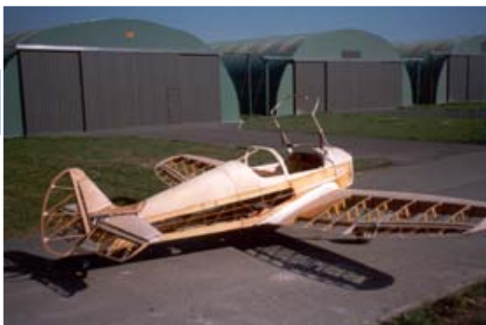
Structure avant entoilage du HN-700 de Christophe Blin (Photo du constructeur)
