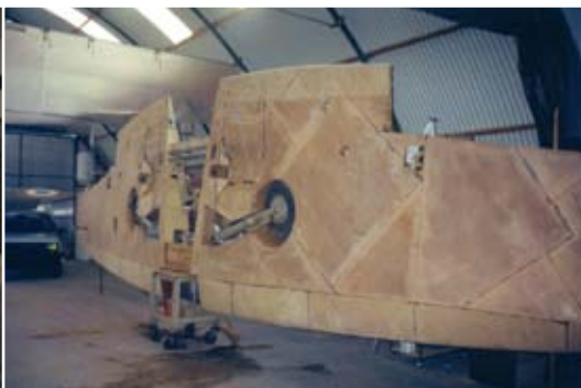
Aile en bois de Bob Deford à Prescott Arizona (USA) (photo constructeur)
