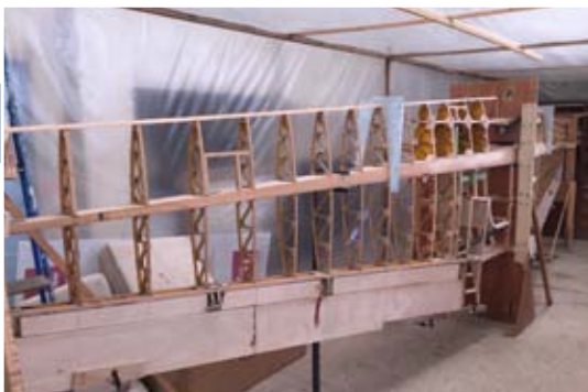
Structure de l'aile d'un Falco en construction à Laval. (photo PC)
