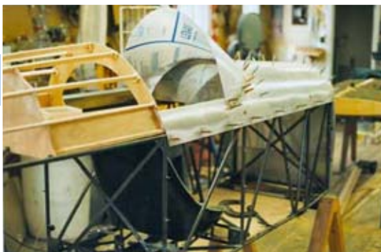
Partie avant du fuselage en tubes du prototype, avec son dome en baguettes abritant le compartiment à bagages.
