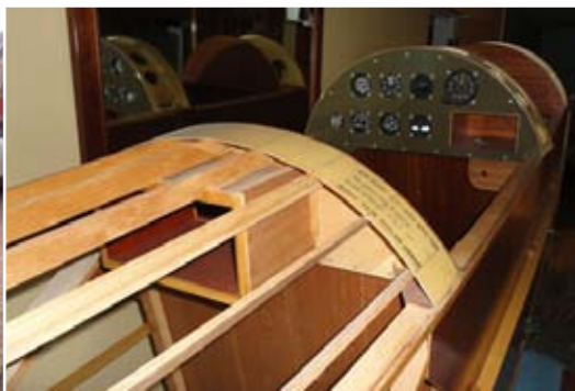
Structure du fuselage (photo concepteur)
