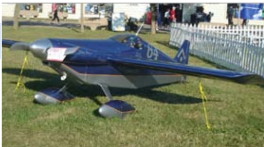
Sonerai I construit par Jeff Lange aux USA, 321 km/h avec un VW 2110 cc (Photo site concepteur)
