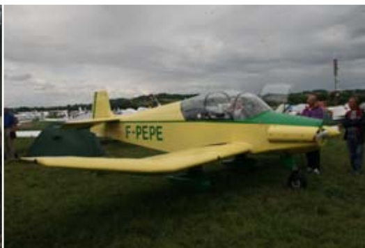
Version train tricycle D116T construit par Jean Anquetil en 1996. (photo C. Ravel)
