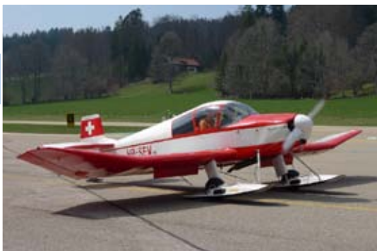
DR1050 Suisse équipé de ski pour le vol montagne. (Photo edos2300 commons.wikimedia)
