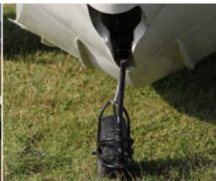
Détail du train avant rentrant du Taylor Coot A de Pierre Husson. (photo PC)
