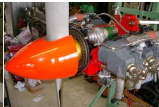
Groupe motopropulseur IO-240A (Photo Camille Gholzan)
