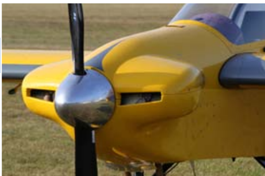
P70S, détail d'un capotage très «travaillé» pour optimiser refroidissement et vitesse. Et en carbone pour le poids.
