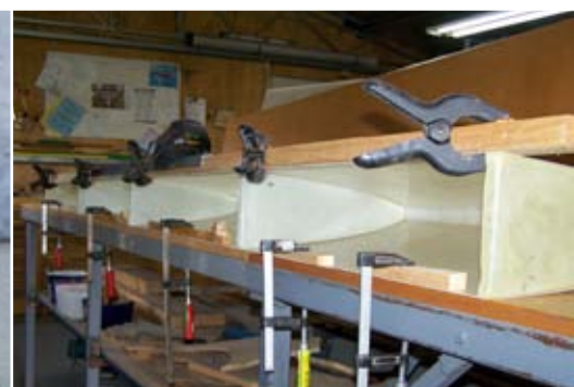
Assemblage d'un réservoir de bord d'attaque de GP-4 (Photo Springfield aviation)
