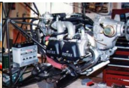
Montage du Rotax 912 sur l'acrolite 1B (Photo acrolite.ca)
