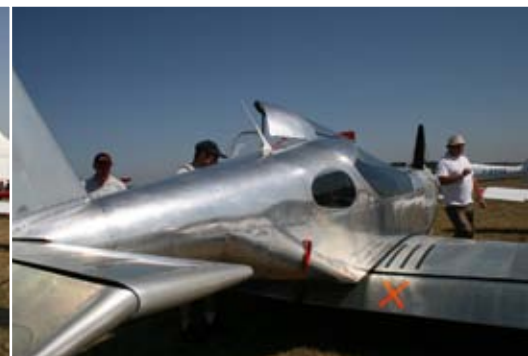
Vue du Karman d'aile en aluminium. (photo PC)
