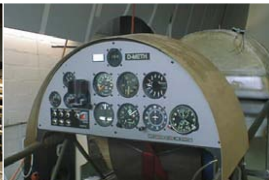
Vue du Tableau de bord arrière et du réservoir central avant en arrière plan. (Photo site constructeur)
