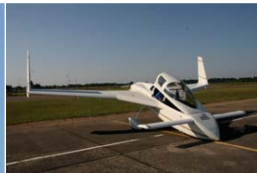
Verrière basculante vers l'avant. La norme est plutôt un basculement latéral. (photo C. Ravel)
