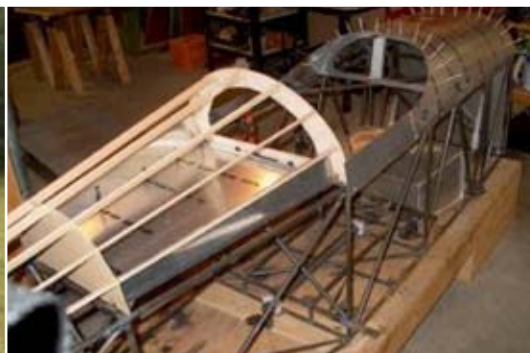
Détail du fuselage tube, avec son dôme en baguettes, vu de 3/4 arrière droit. (Photo acrolite.ca)
