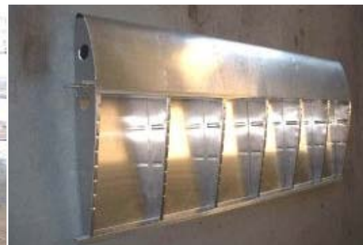
Structure de l'aile du CX4 (Photo site concepteur)
