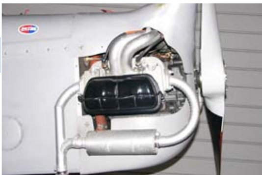
Exemple de moteur VW monté sur un Volksplane (Photo Ahunt commons wikimedia)
