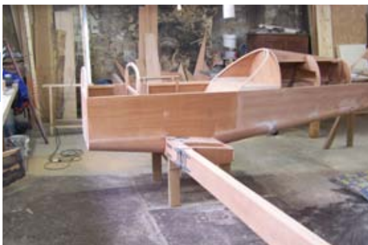
Vue de la cellule mise en croix (Photo concepteur)
