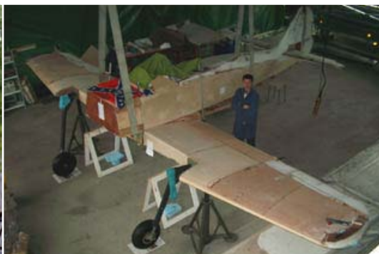
Mise en croix du MJ-8 construit par Gilles Küpfer (Photo constructeur)
