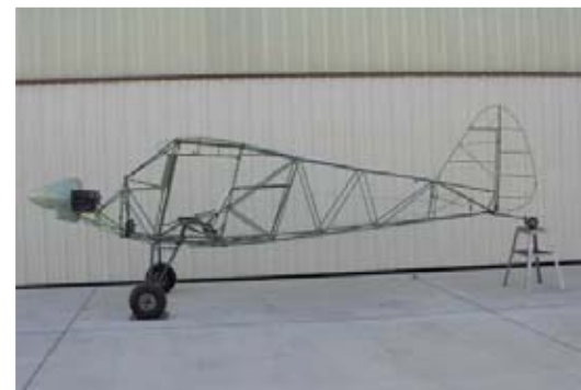
Structure du fuselage du Wag-a-Bond a moteur Corvair (photo Dave Vargeso / www.flycorvair.com)
