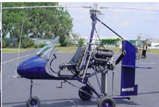
Dominator avec moteur Rotax 582 (photo concepteur)
