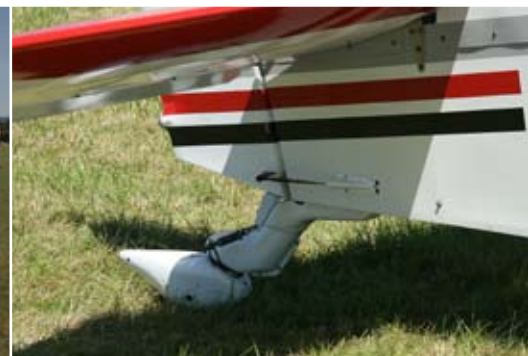
DR1050M construit par Pierre Peuzin en 1995. Notez le carénage de la roulette de queue (Photos PC et C. Ravel).
