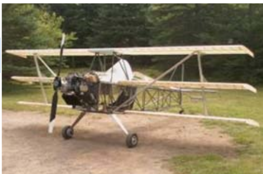
Le prototype avant entoilage (Photo acrolite.ca)
