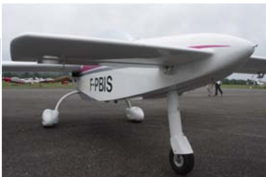
Détail du fuselage, du plan canard et du train, vue de l'avant droit. (photo PC)
