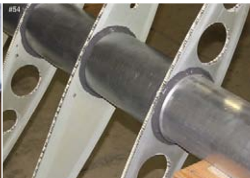
Nervures en sandwich aluminium nid d'abeille collées sur le longeron tubulaire. (Photo concepteur)
