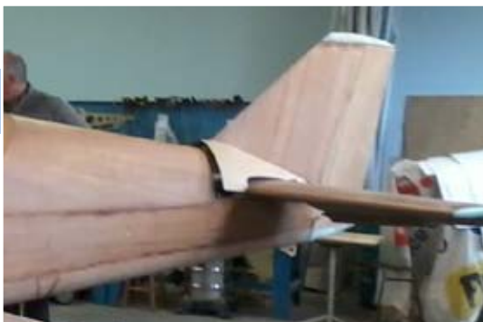
Empennages du JPM05 Layon, prototype en construction par Jean-Pierre Delage (Photo concepteur)
