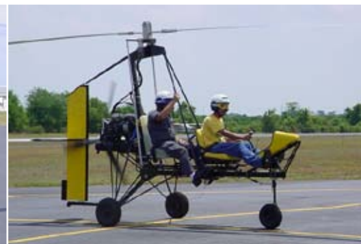
Version biplace du Dominator avec moteur Hirth (photo concepteur)
