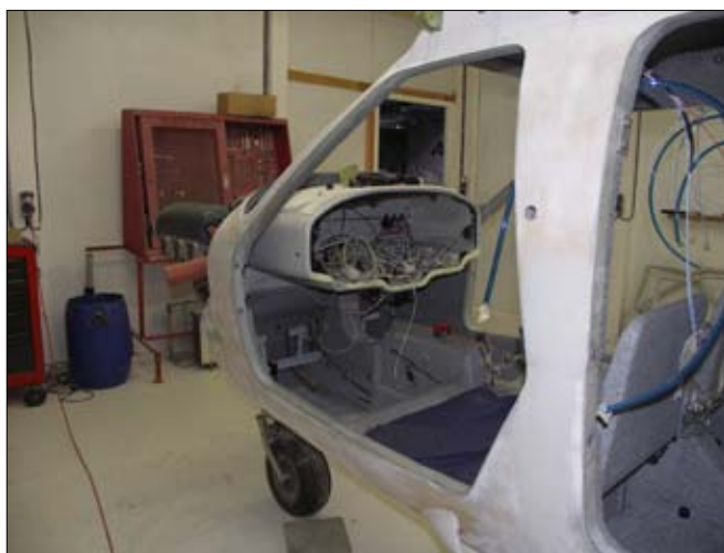
Montage d'un kit en composites de Jabiru J400
