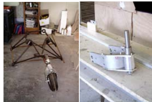
Train avant soudé au bâti moteur du Joker construit par l'aéro-club de la Haute Marne entre 2004 et 2008.
