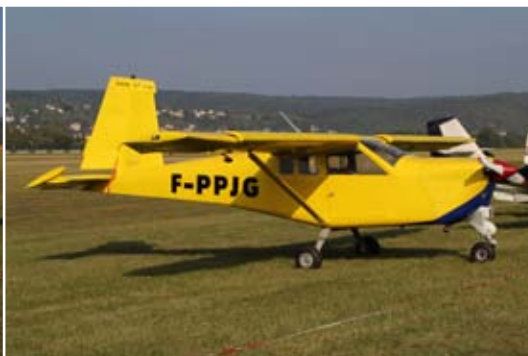
Lucas L7-160 triplace construit par Pierre Portier en 2005, ici avec le train avant rendu fixe à roue tirée, sur une base Rallye MS880. (photo PC)
