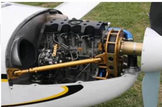
Moteur PSA Diesel avionné par Jean-Jacques Ballot. (photo C. Ravel)
