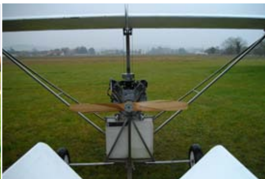
Vue arrière avec moteur Honda GX690 (Photo concepteur)
