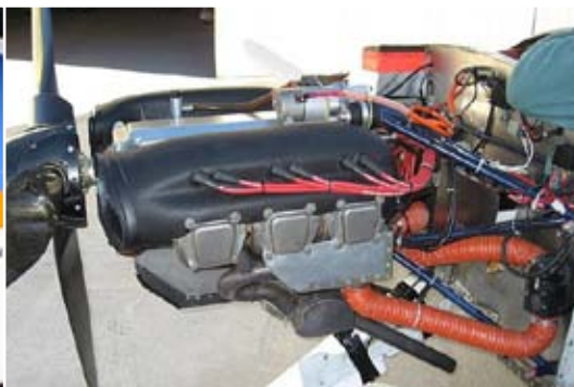
P180S Construit par Albert Abel en 1990 et équipé d'un moteur Jabiru 3300 (Photo Yves Ravoux)
