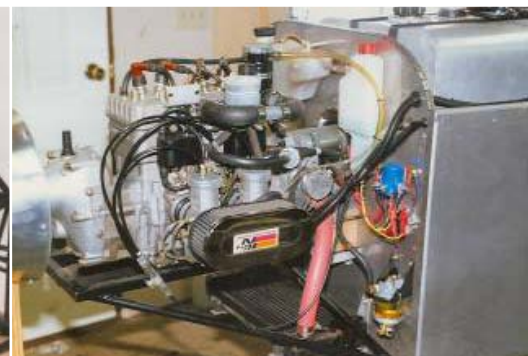
Bloc moteur Rotax 582 de l'Acrolite 2M (photo concepteur)
