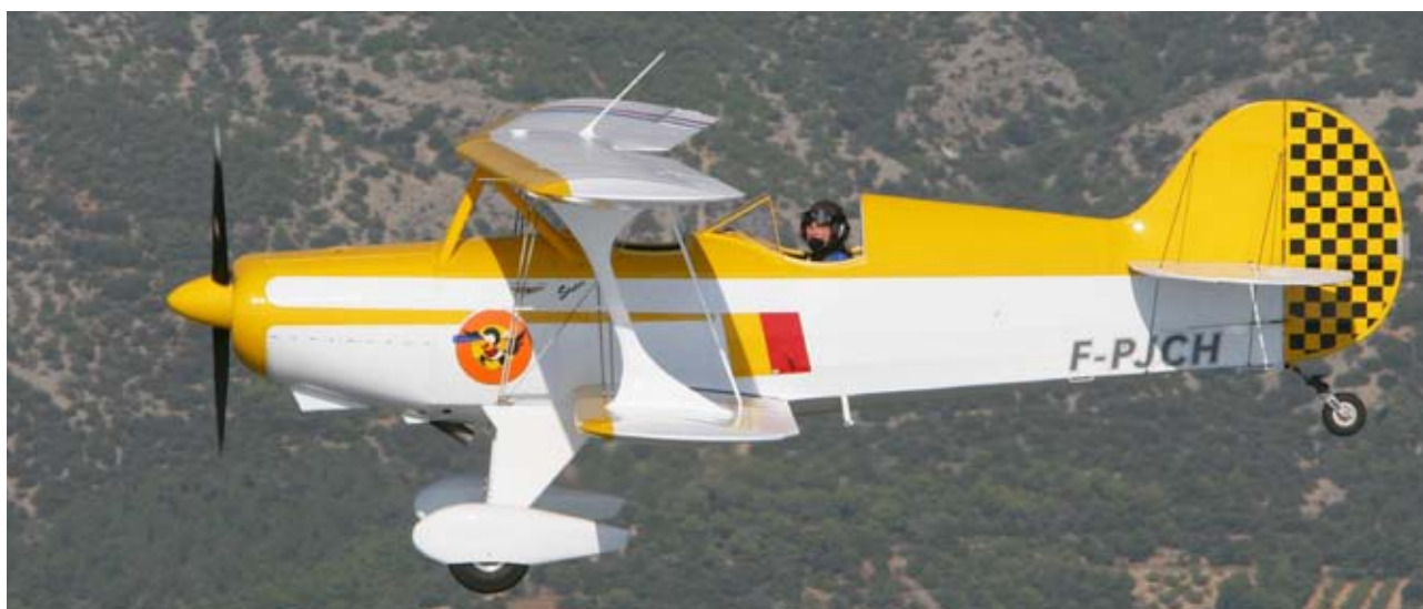
Avion biplace de voltige en tubes et toile, aile en bois, Steen « Skybolt » de 250 cv
