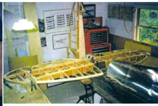
Empennages bois sur fuselage tubes et tôles de Bob Deford. (photo constructeur)
