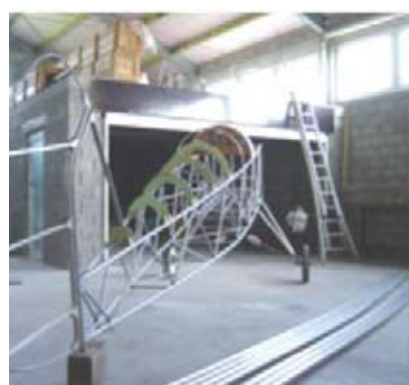
Fuselage en tubes soudés du Kiebitz
