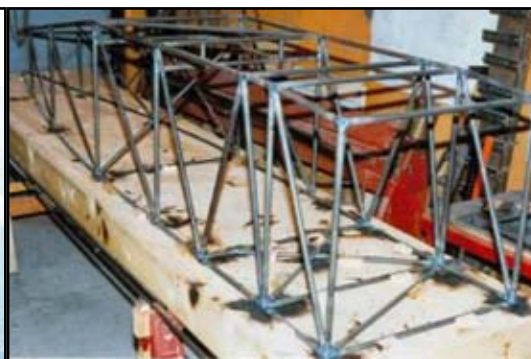
Chantier de soudage du fuselage de l'acrolite 1B (Photo acrolite.ca)
