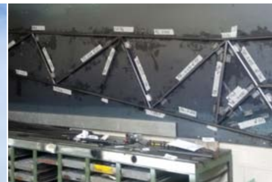
Structure en tubes d'un flan de fuselage (Photo concepteur)
