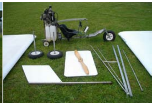
Spratt 103 démonté en 20 minutes (Photo concepteur)
