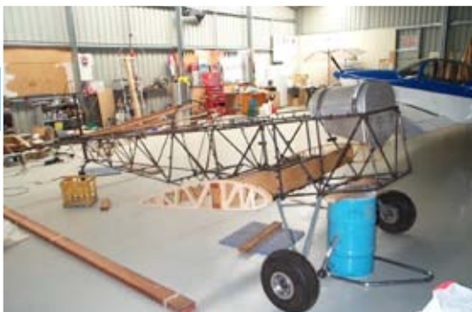
Fuselage en tubes, réservoir en aluminium, train et partie centrale du longeron en bois (photo Martin Hone, Rotec)
