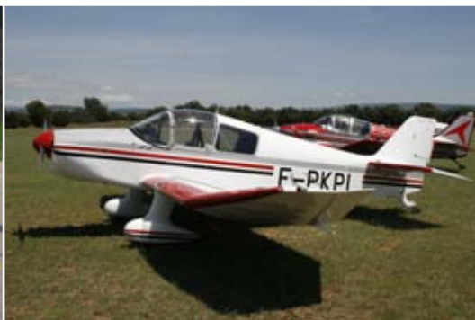
DR1050M construit par Pierre Peuzin en 1995. Notez le carénage de la roulette de queue (Photos PC et C. Ravel).
