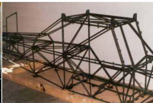
Structure du fuselage de l'Acrolite 2M (photo concepteur)
