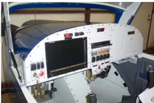
RV-12 équipé en EFIS Dynon (photo concepteur)
