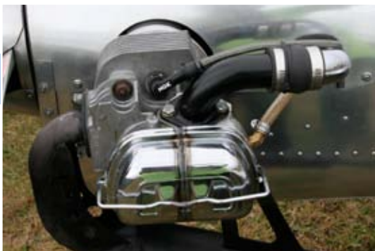
Motorisation bi-cylindre refroidi par air (Photo Christian Ravel)
