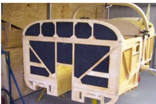
Structure du fuselage du GP-4 (Photo Springfield aviation)
