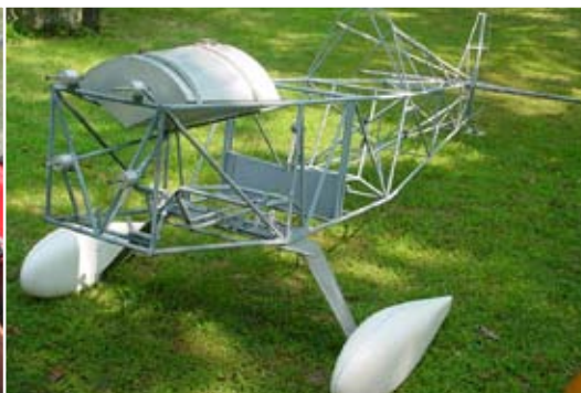
Fuselage en tubes (Photo FlugKer12 commons.wikimedia)
