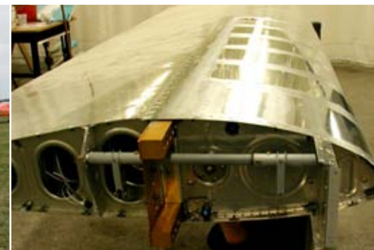
Vue du longeron à l'emplanture de l'aile gauche.
