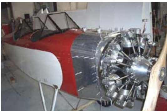
Montage du moteur Rotec (Photo Hevle Aviation)
