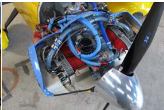
P70S, moteur VW 1835cc avec allumage mixte électronique / magnéto. (Photo Benoit Hetzel)
