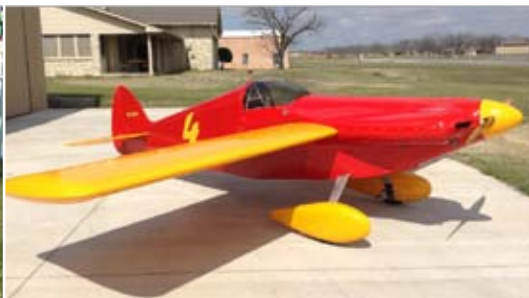
Sonerai I construit par Kevin Ross aux USA, équipé d'un moteur VW 1835 cc (Photo site concepteur)
