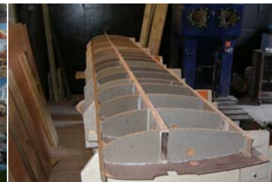
Structure de l'aile (photo concepteur)
