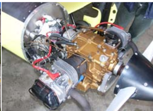
Vue du demi-VW équipant un Hummel Bird. (Photo Hummel Aviation)
