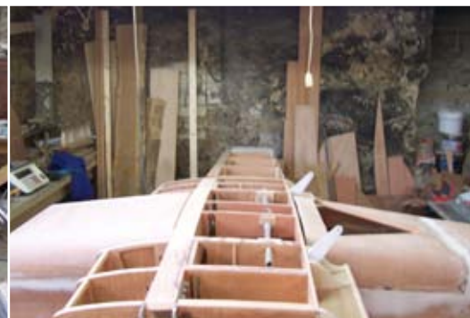
Vue de la structure de l'aile (Photo concepteur)
