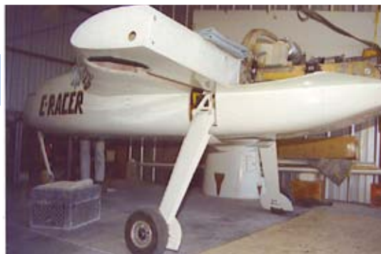
Train rentrant du E-Racer vu de l'arrière gauche. Les ailes sont démontées. (photo concepteur)
