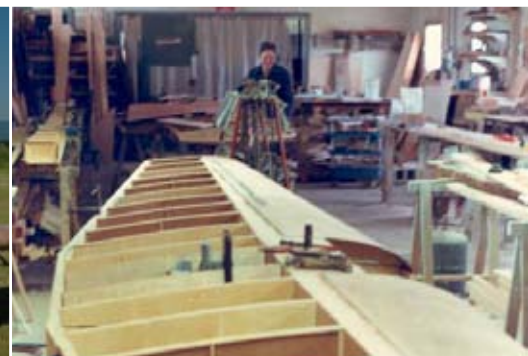
Structure de l'aile (photo RSA)
