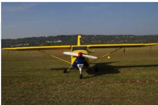
Lucas L7-160 triplace construit par Pierre Portier en 2005, ici avec le train avant rendu fixe à roue tirée, sur une base Rallye MS880. (photo PC)
