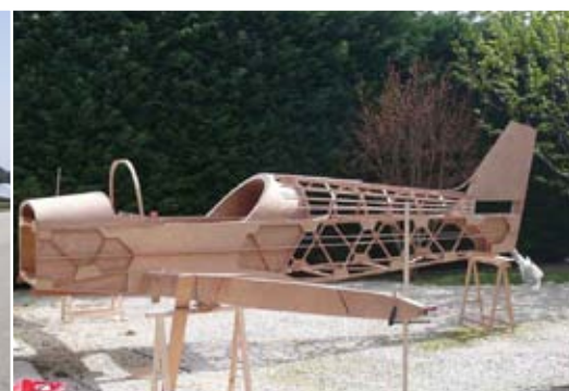
Structure du fuselage (photo site Avions Piel)
