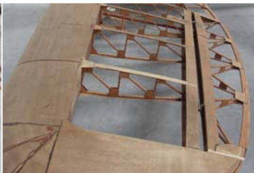
Aile gauche avant entoilage. (photo PC)
