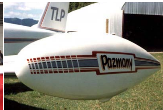
Réservoir de 47 litres en bout d'aile (Photo www.pasmany.com)
