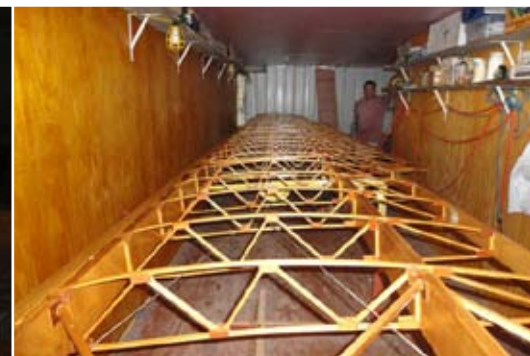
Structure de l'aile (photo concepteur)
