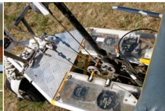
Détails de la place avant et du tableau de bord sous les jambes pour limiter la trainée ! (Photo C. Roland)
