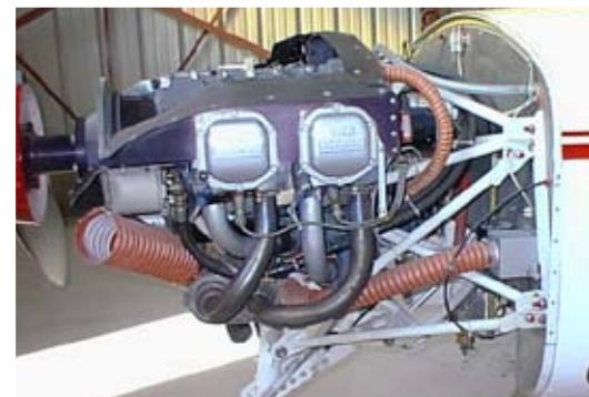
Groupe motopropulseur du Lucas L8 construit par Michel Miard en 1999 (Photo Jean Pottier)
