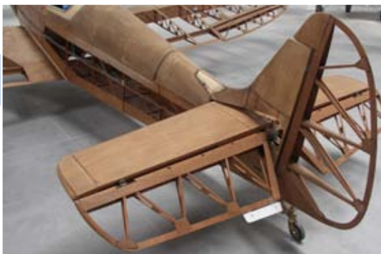
Empennages avant entoilage. (photo PC)
