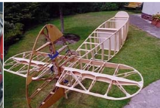
Structure du fuselage et des empennages du Taylor Monoplane (Photo Rick Braat)
