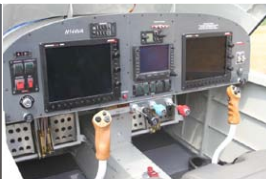
RV-14A équipé double EFIS Dynon (photo concepteur)
