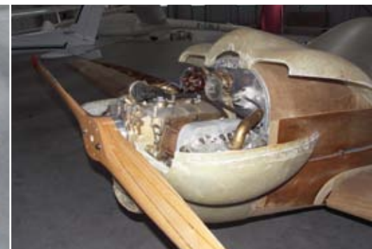
Groupe motopropulseur de type VW. (photo PC)
