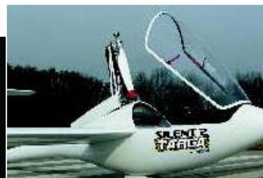
Silent 2 moteur sorti (Photo concepteur)
