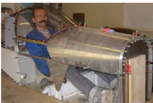
Structure du fuselage du P80SMR d'Alain Rougetet (Photo concepteur)
